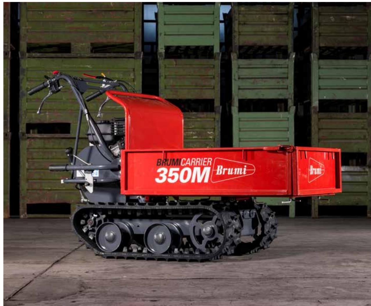
Il modello più compatto, pratico e versatile. Il cassone, con portata utile di 300 kg, ha piano e sponde in acciaio e risulta ulteriormente espandibile, bloccando in posizione orizzontale le sponde così da aumentare la superficie di carico. Il cassone dispone di ribaltamento anteriore manuale di serie, fino a 90°, assistito da molle a gas per ridurre la forza necessaria durante lo scarico.
