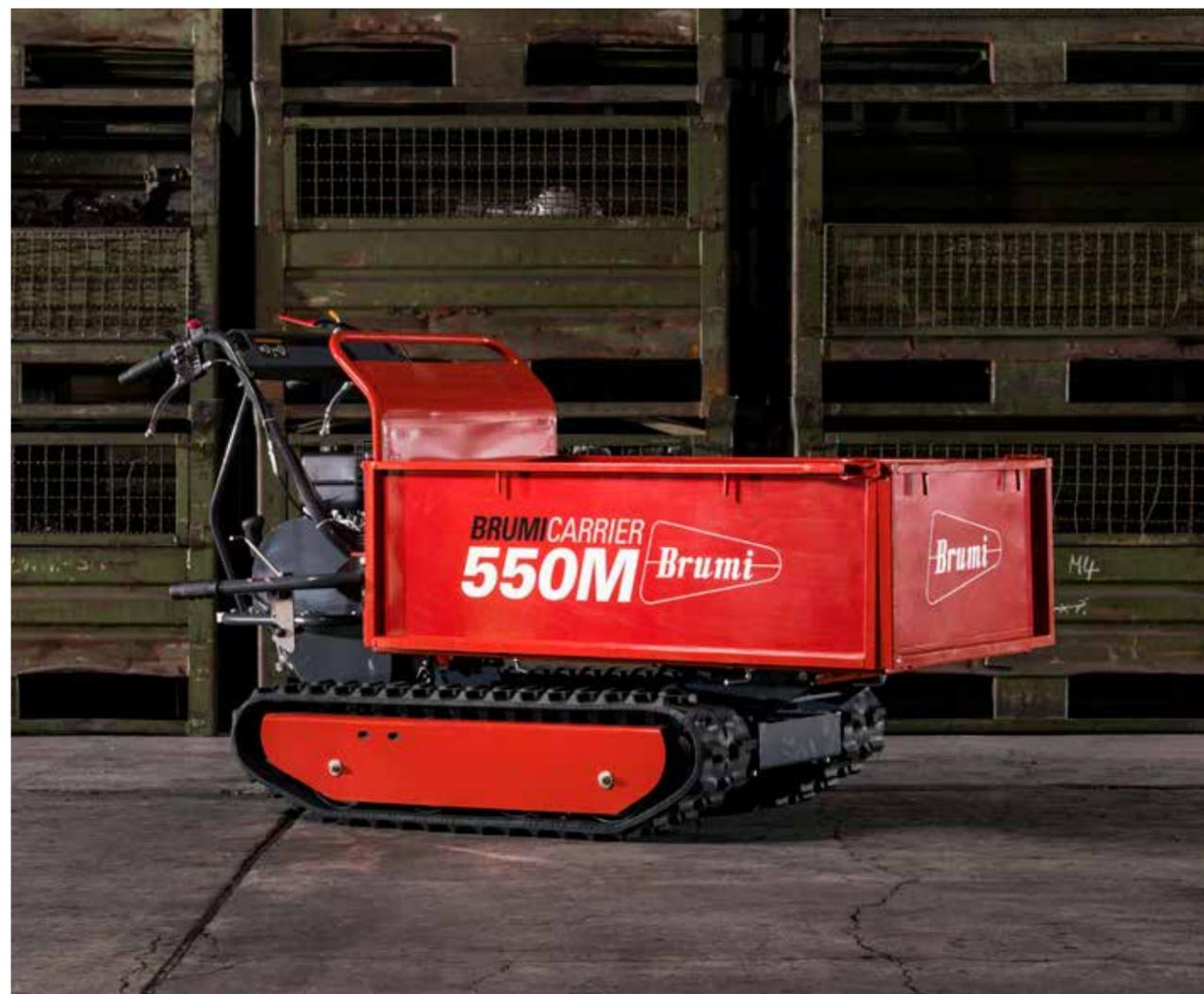
Stessi pregi, stesso motore e identiche dotazioni meccaniche, il BrumiCarrier 550 è il fratello maggiore della gamma, con la sua portata utile garantita di 500 kg. Ideale quindi per chi ha necessità di trasportare carichi più elevati o di ridurre il numero degli spostamenti, sfruttando il piano di carico più ampio, a costo di perdere qualcosa in manovrabilità, punto di forza del BrumiCarrier 350.
